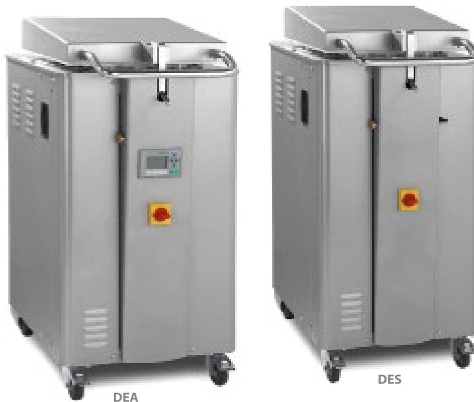
Macchina adatta per la spezzatura di pasta da pane e pasticceria. Struttura in acciaio verniciato a forno. Disponibile versione inox. Dimensioni ridotte. Vasca e coltelli in acciaio inox AISI 304. Esagoni in nylon alimentare. Centralina idraulica a spegnimento automatico silenziosa e affidabile. Pulsante pulizia coltelli. Funzionamento completamente idraulico.
